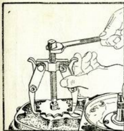
Рис. 20 Стягивание цепочной звездочки вторичной передачи
